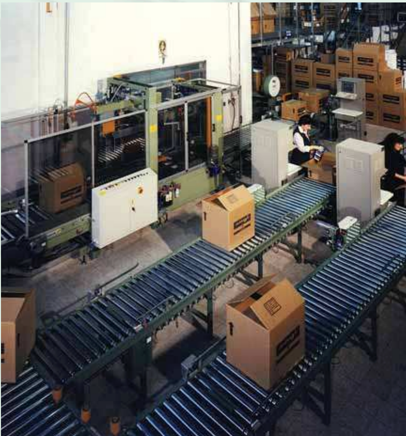
Linea di trasporto interno ed imballaggio di scatole con formatura automatica dei colli. Inside conveying line with parcel packing, and automatic box making.
