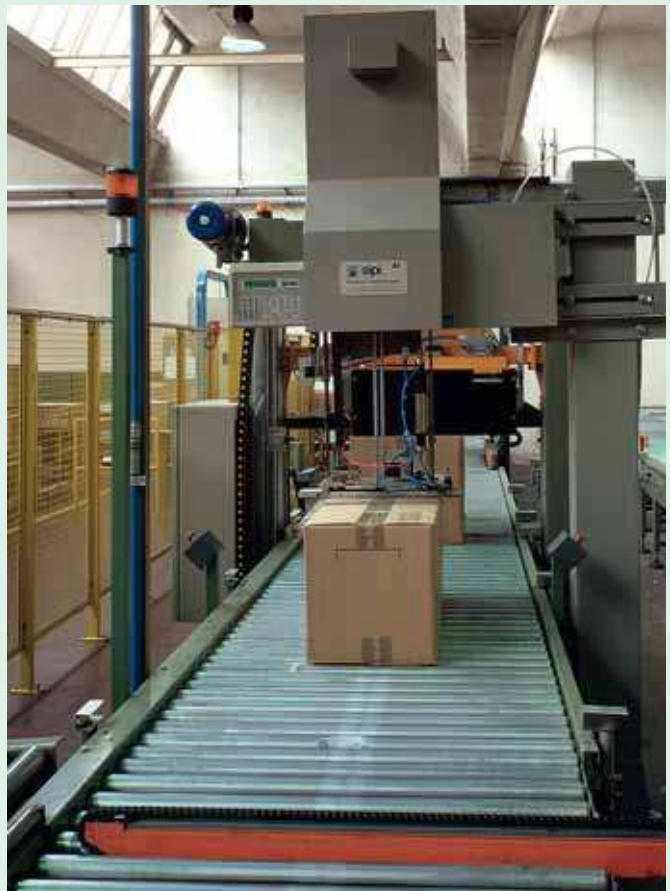
Fine linea con nastratura, reggiatura ed etichettatura dei colli. End of line system with taping, strapping and parcel labelling process.
