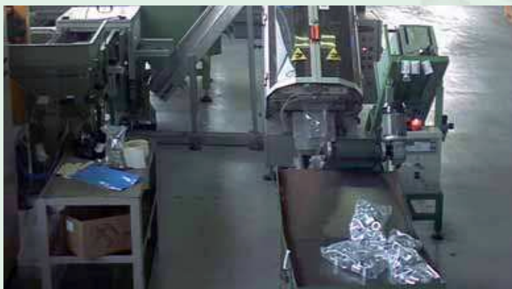
Impianto di confezionamento di minuterie metalliche Packing system for nuts and bolts
