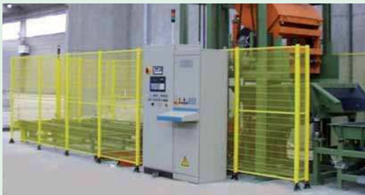
Impianto per il controllo e la gestione del carico e dello scarico dei forni di bonifica. Control and management system for the loading and unloading process of the furnaces
