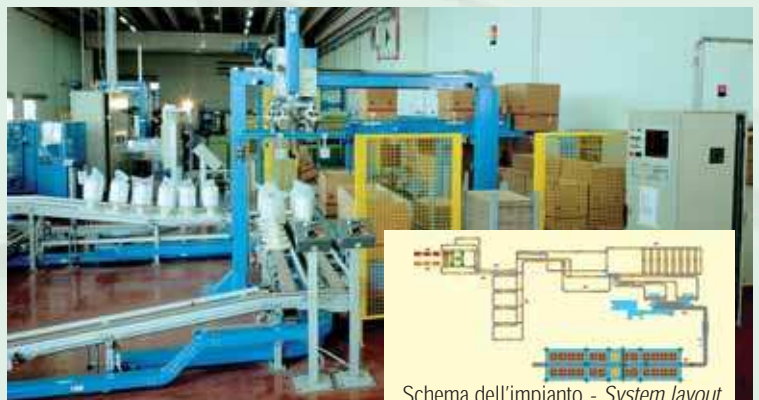
Impianto per la cernita e l'imballaggio di bobine di filo sintetico System for the inspection and packing of synthetic yarn bobbins
