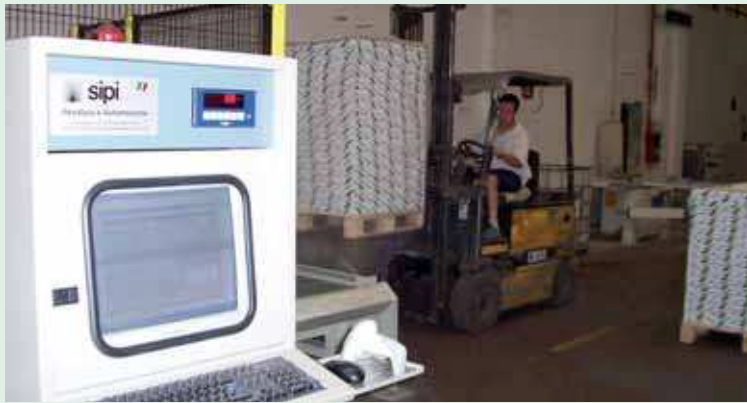
Impianto di pesatura ed etichettatura di pallet e bobine per le industrie cartarie e tessili. Weighing and labelling systems for pallets and bobbins for paper and textile industries
