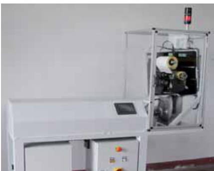
Etichettatore per etichette di dimensioni A4 con verifica del codice a barre applicato. Labelling system for A4 labels, with check of the barcode applied.
