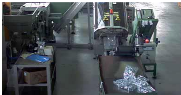
Impianto di confezionamento di minuterie metalliche. Packing system for nuts and bolts.
