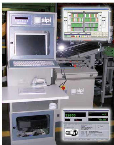
Postazione pc per il controllo delle funzioni di pesatura con videate di un sinottico e di un sistema contapezzi.
